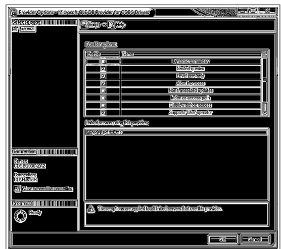
Abbildung 4.10: Anwendung der adaptiven Schwellenwertmethode auf einen Beispielscreenshot. Die bei unangepasster Blockgröße entstehenden Artefakte schränken die Funktionsweise des Texterkennungssystems deutlich ein.
